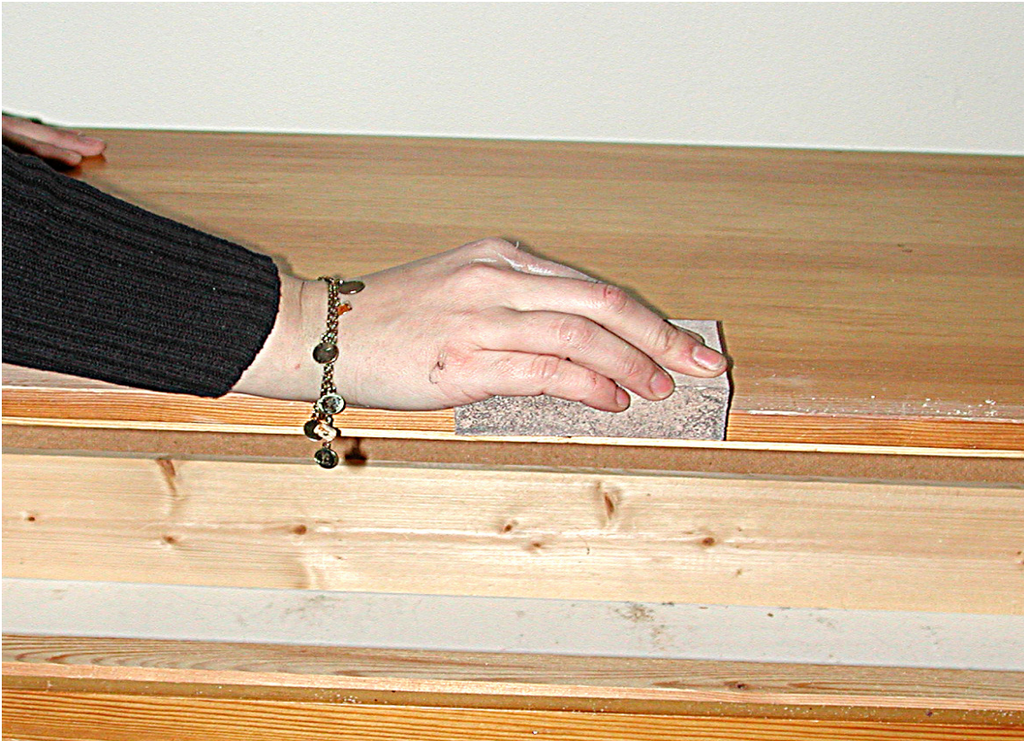
3. Grunn deretter med fargen du ønsker i bunn i krakkeleringen. Her har vi benyttet en brun grunning.
