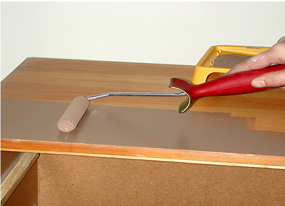
4. Så påføres middelet som gjør at toppstrøket krakkelering.
