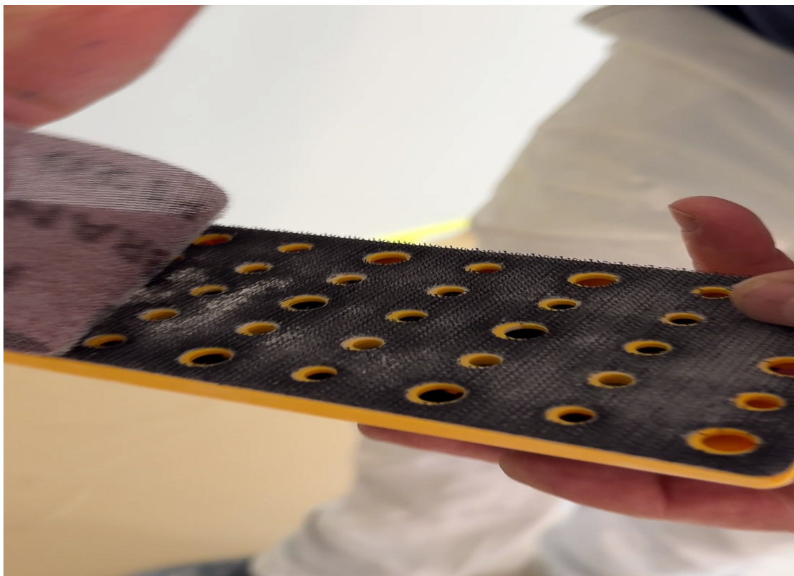
RETT I STØVSUGEREN: Slipepapiret er gjennomhullet, og slipeklossen har hull som gjør at støvet trekkes inn i støvsugeren.
