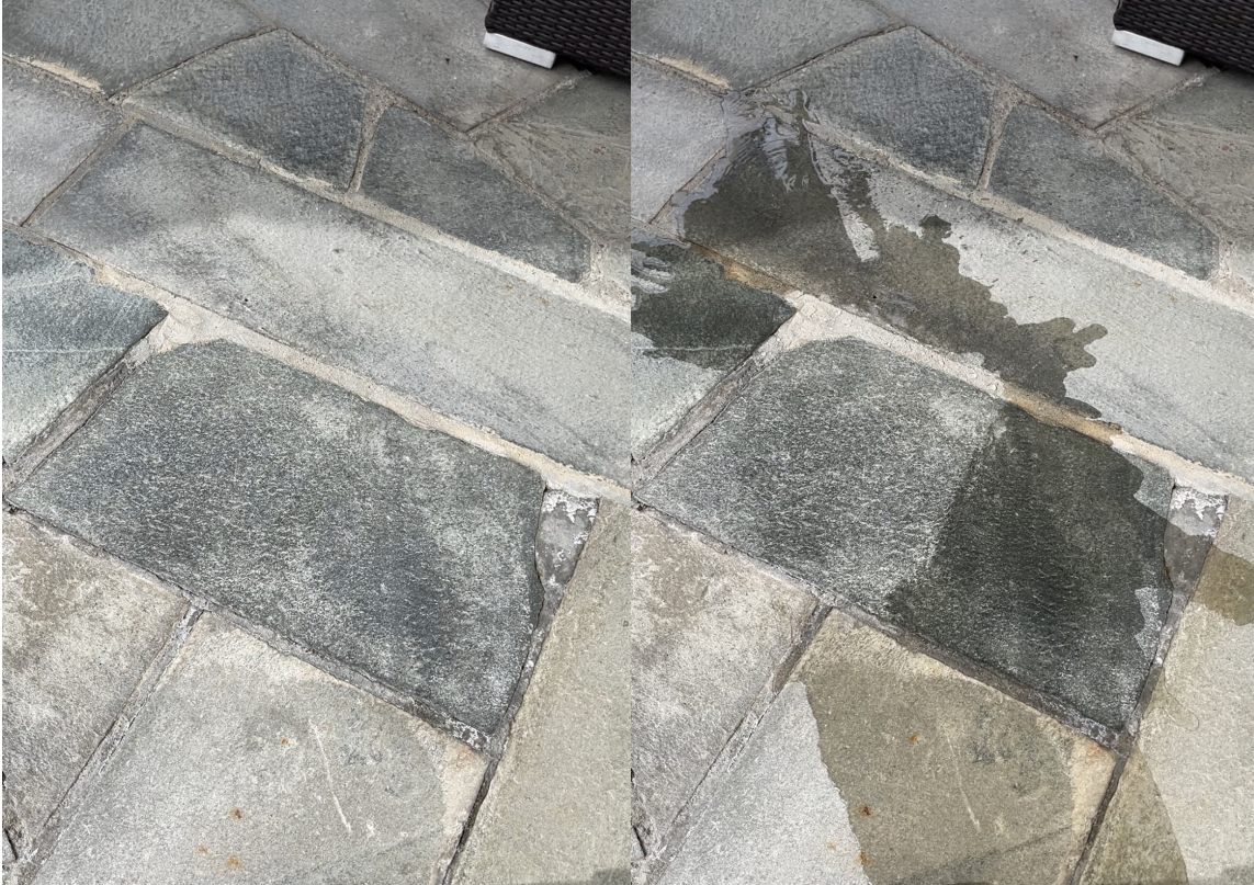
FØR OG ETTER: Når det kastes på en bøtte med vann, ser man tydelig hvor impregneringsvæsken har vært penslet på.
