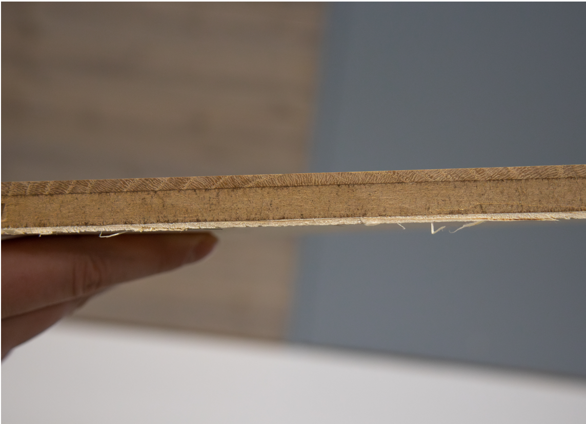
TVERRSNITT: Oppbyggingen til et parkettgulv består av et bunnsjikt (nederst), en solid kjerne av tre, og et toppsjikt (øverst) på minst 2,5 millimeter.
