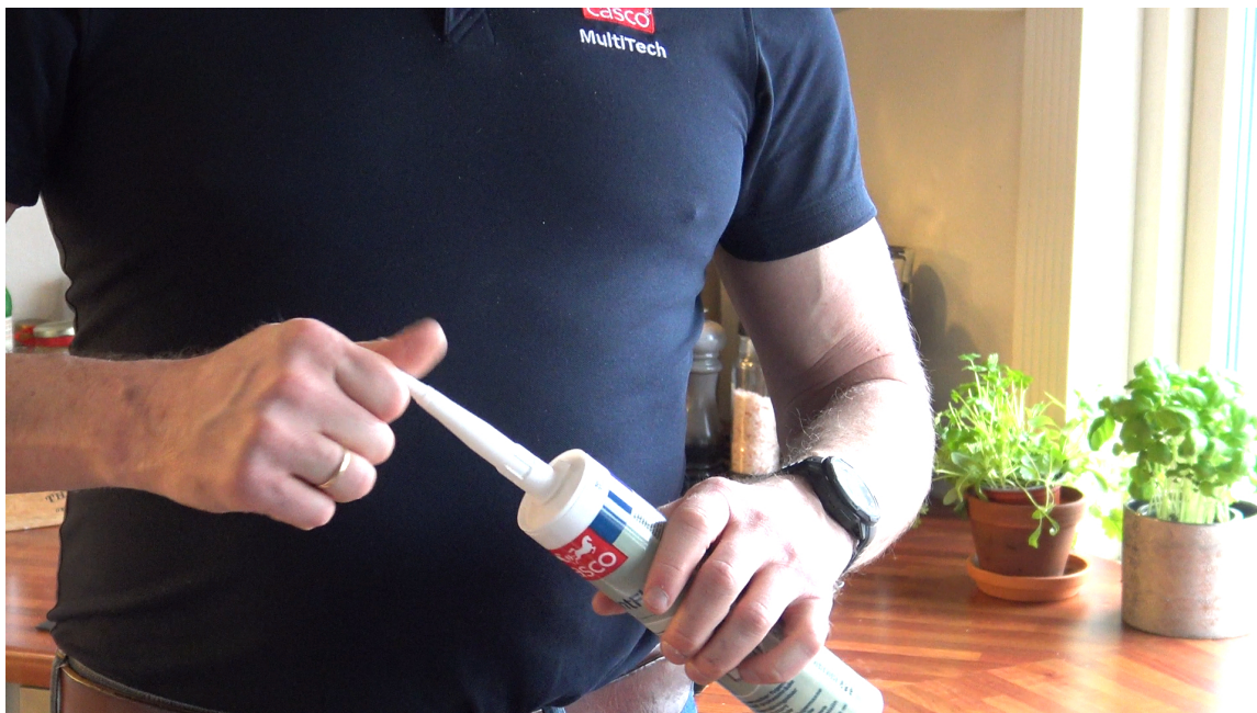
SPISS: Fugespissen må skrues riktig på slik at fugemassen ikke stivner ned i patronen.
