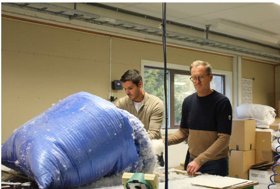
FYLLER GÅSEDUN: Halvor Bakke og Julian Bjørnerem fyller kamrene i maskinen med gåsedun. Hvert kammer fylles med 22 gram gåsedun.
