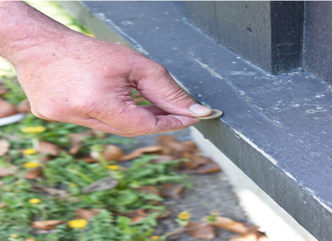
VEDHEFTKONTROLL: Skrap lett på malingen på utsatte steder for å sjekke at den fortsatt sitter godt fast på underlaget.
