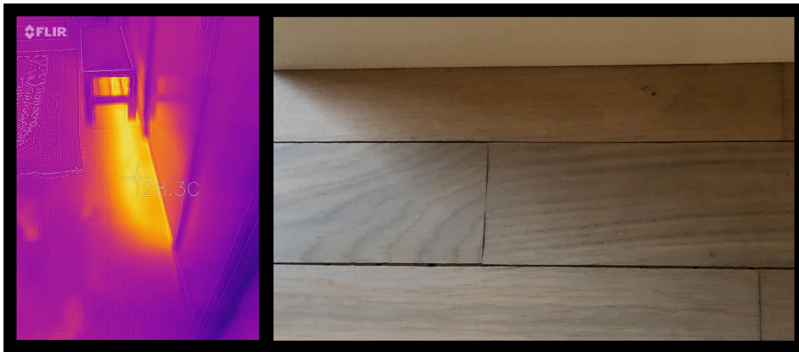
MAKS TEMPERATUR: Gulvleverandører anbefaler som regel at den maksimale temperaturen i gulvets overflate aldri overstiger 27 °C. Bildet til venstre viser lokal oppvarming og bildet til høyre viser resultatet på parketten.
