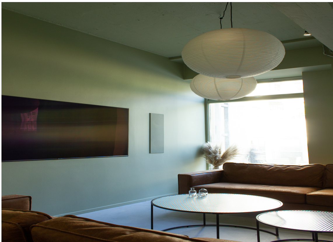
GJENNOMGÅENDE GRØNN: Tak og vegger i stuen er malt i fargen S 3010-G60Y i en matt maling med glans 5. Trappeløp og entré har samme farge. Legg merke til detaljene. Alle lister og stikkontakter er også malt.
