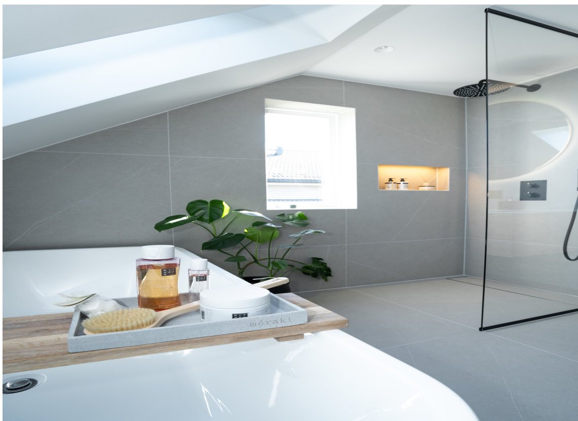
SATS PÅ SLUKEN: Takdusjer gir en deilig spa-følelse. Samtidig kommer det store mengder vann fra den, og krever et sluk som tar unna deretter. Her har huseieren valgt et rennesluk med flislagt slukrist og en vannlås som er enkel å rengjøre.
