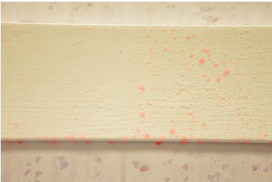
REGNER BORT: Den selvrensende effekten gjør at vannet forsvinner forttere fra fasaden. – De skitne vannråpene tørker ikke inn på veggen, men renner vekk og tar smusset med seg, forklarer Anders Hvinden hos Butinox.
