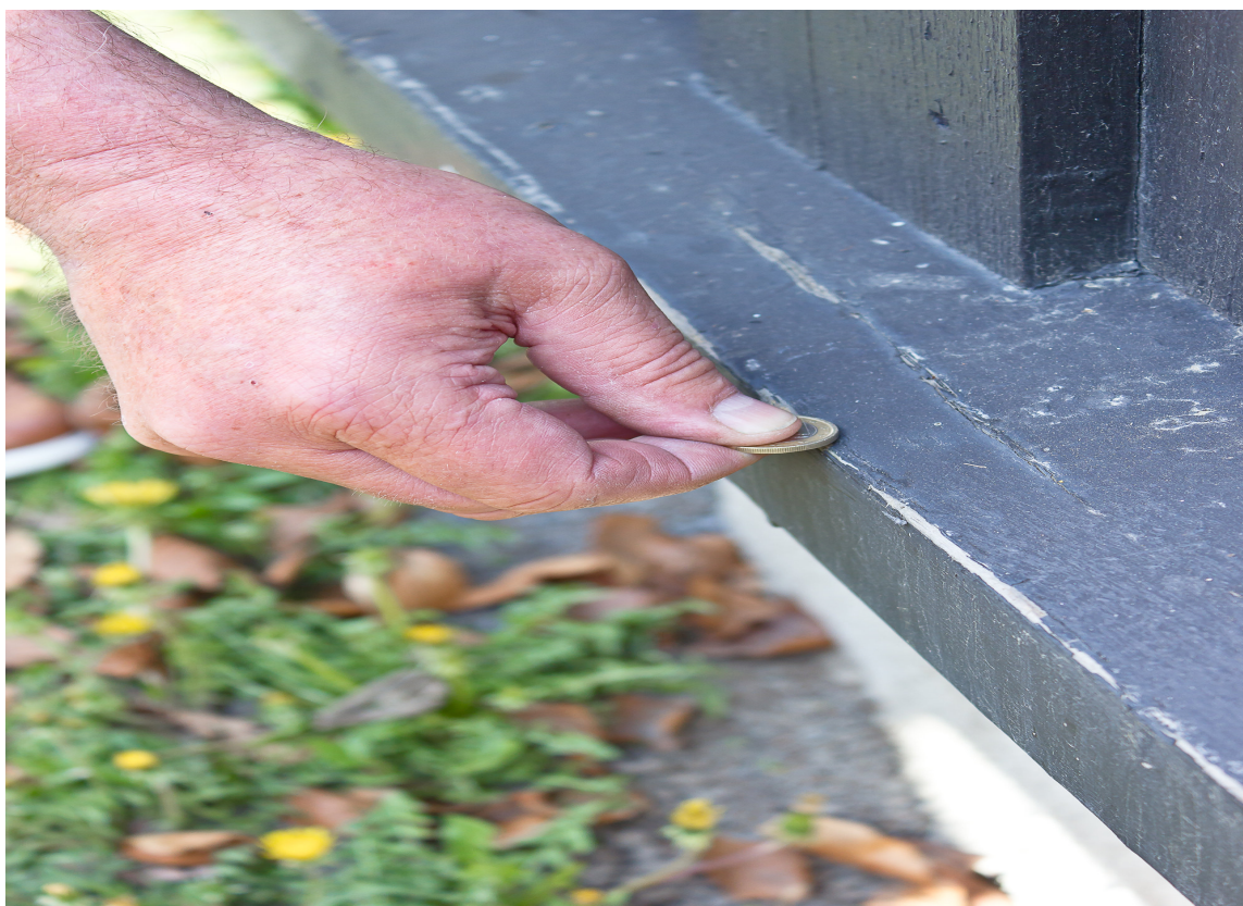
VEDHEFTSTEST: Skrap forsiktig med en mynt for å se om malingfilmen fortsatt har vedheft.
