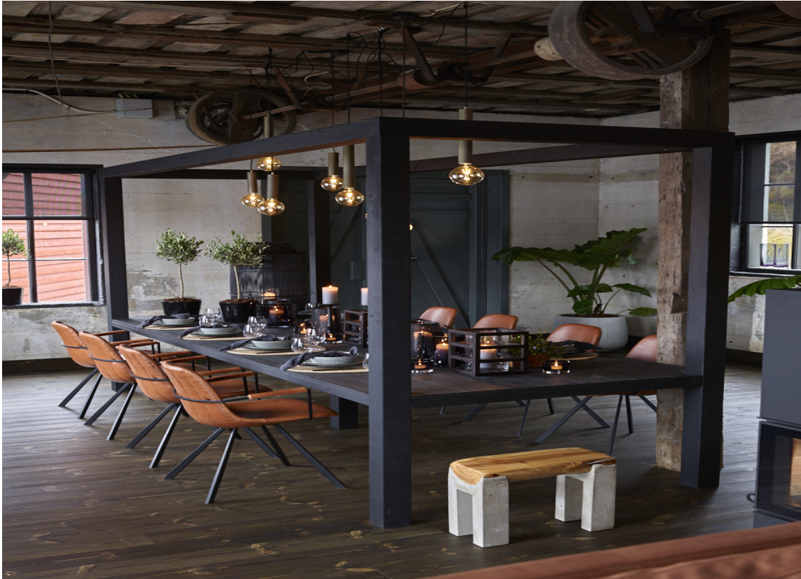
FURUGULV: Det er lagt nytt furugulv over det gamle betonggulvet. Nyslipt furu behandlet med 1-2 strøk Original Panellakk matt i farge 806 Trollheimen og 2 strøk Nordsjö Original Parkettlakk på toppen gir samme utseende.
