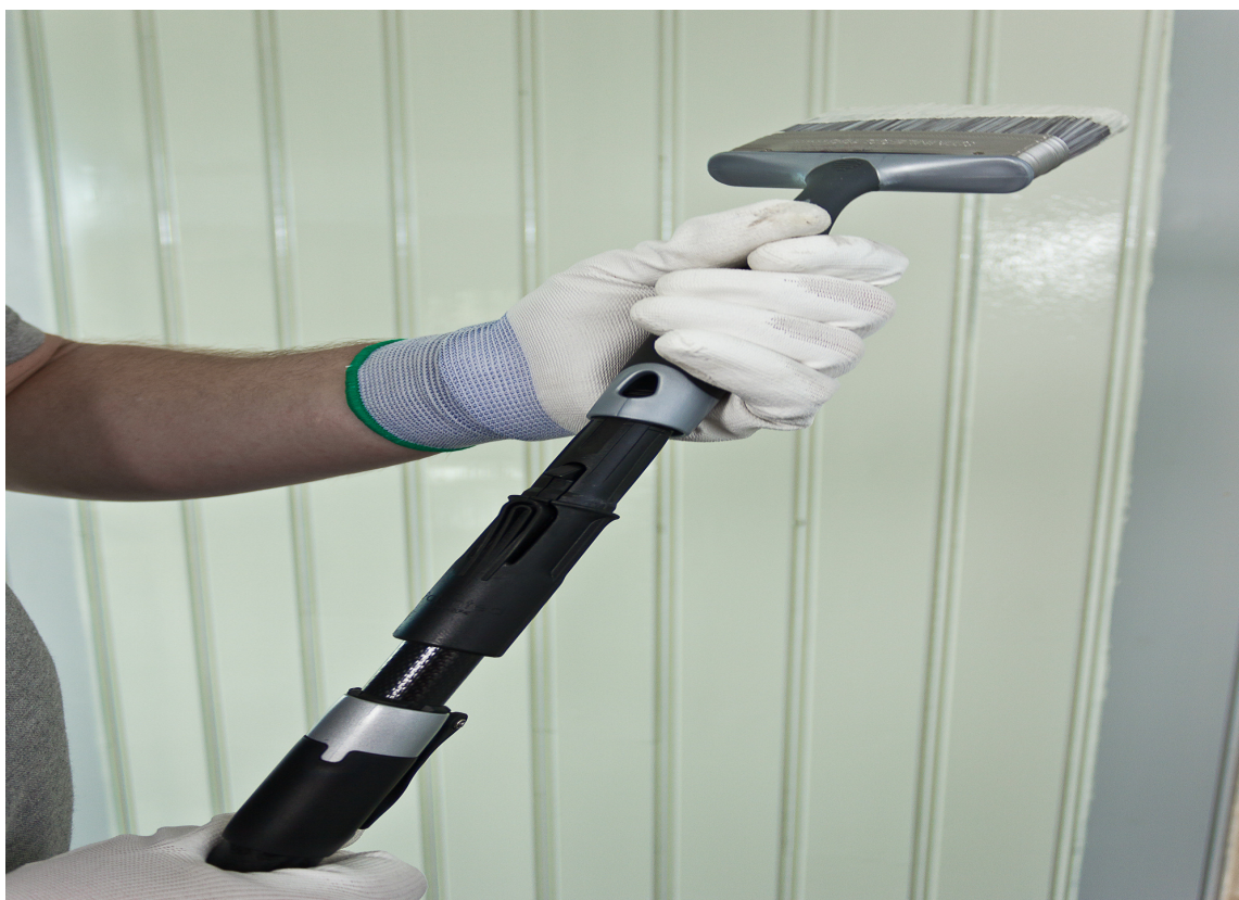
FORLENGET ARM: Festet på forlengerskaftet passer til mange ulike pensler og ruller. Med et lett klikk har du satt verktøyet på plass.
