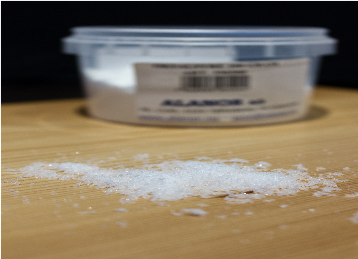
SURT STOFF: Løs opp oksalsyrekrystaller i vann og drypp det over flekken. Oksalsyre er et meget surt blekemiddel for tre og lær, som ikke er giftig.
