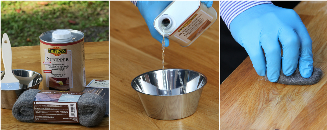
RENS: Rengjør flaten skikkelig før du påfører ny behandling.
