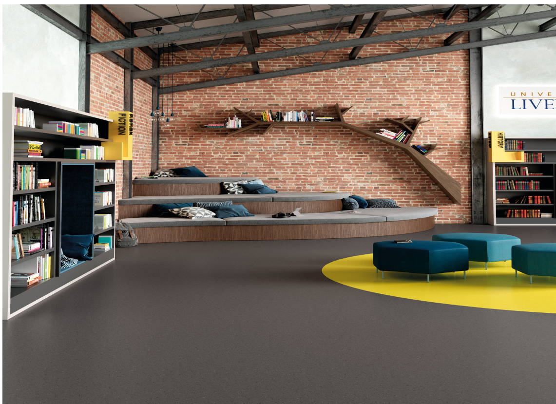
HEL VED: Palettone er et fleksibelt, homogent vinylbelegg med 2 millimeters tykkelse. Belegget når bruksklasse 23/33/43 i henhold til EN 685 / EN ISO 10874.
