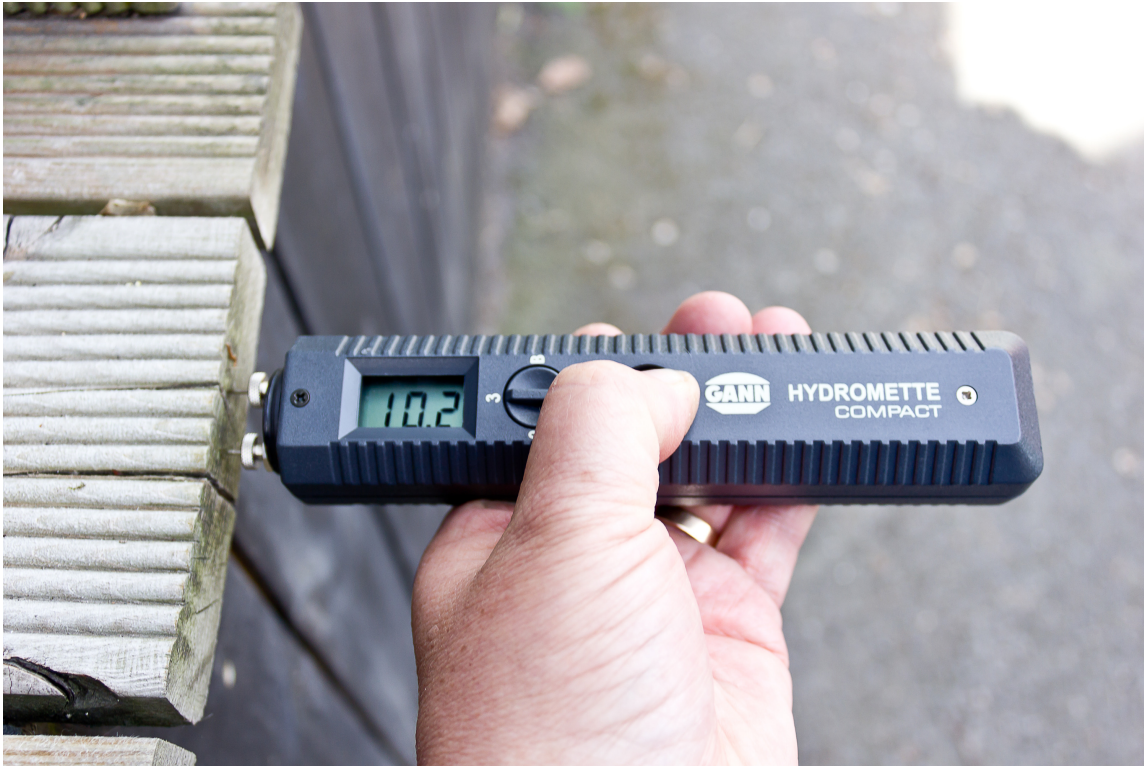
SALTAVVIK: Kobbersaltene i impregnert treverk kan gi usikre målinger, men kan fortsatt gi en indikasjon på om terrassen er tørr nok for beising.
