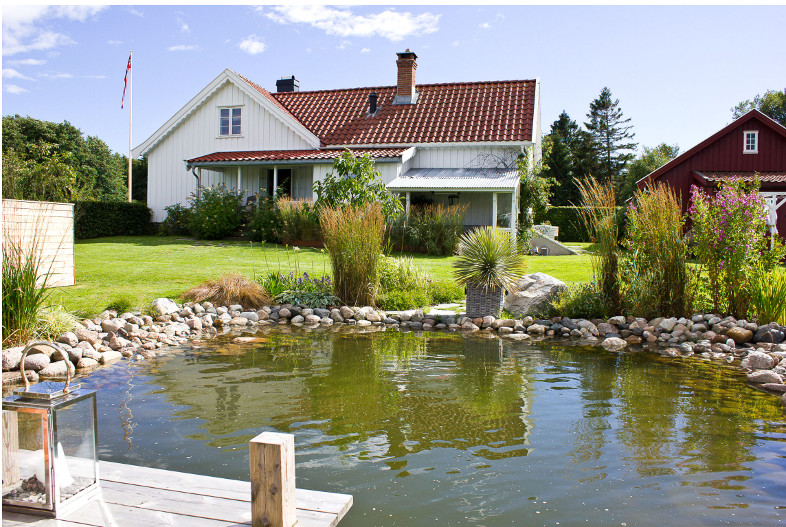
MEDITASJON: Halvor hadde lyst på lyden av vann. Det ble dam, jorda ble gravd bort, deretter ble det lagt duk og dekket til med stein.
