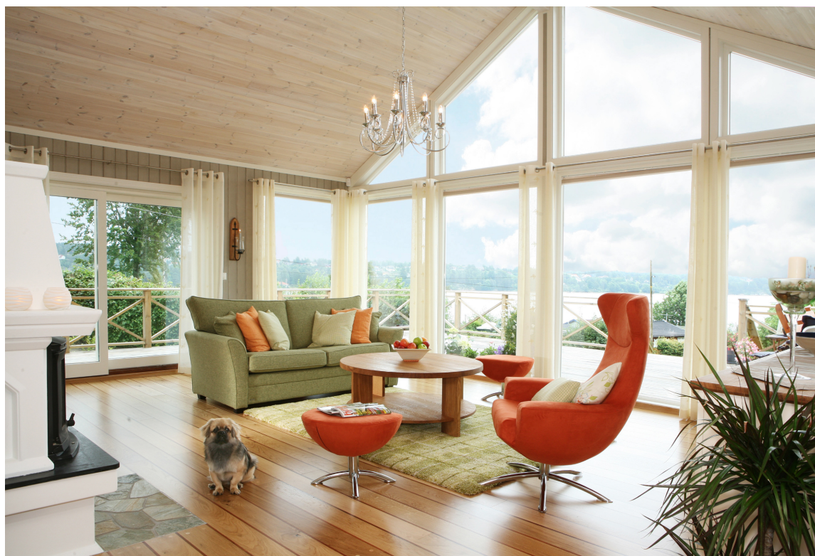
SJØHYTTA: Fuktig luft fra havet gjør at parketten på hytta kan svulle. Ved flytende legging er klaring mot vegger og faste installasjoner viktig.
