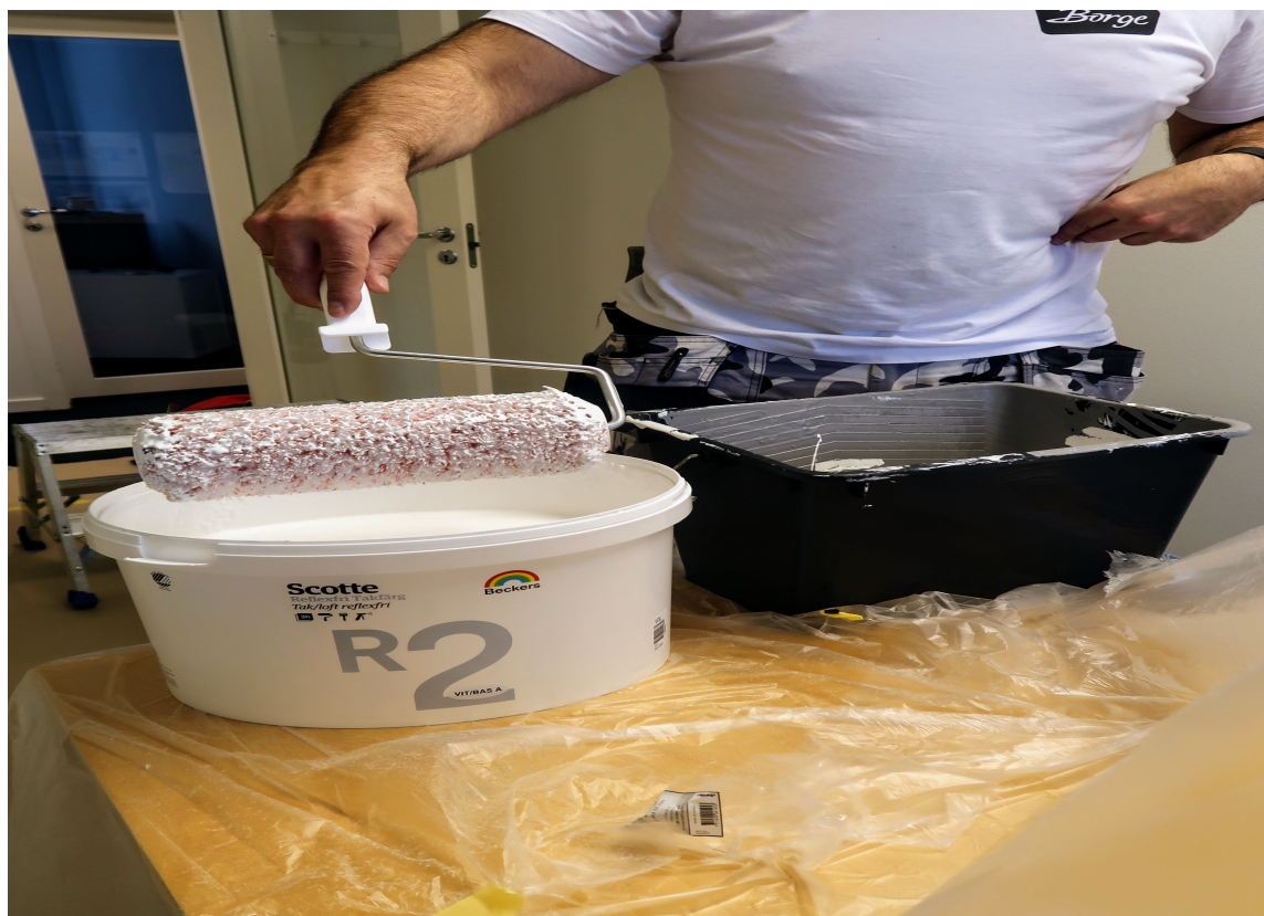
RETT I BØTTA: Den ovale formen gir også plass til at maleren kan dyppe rullen rett i spannet.
