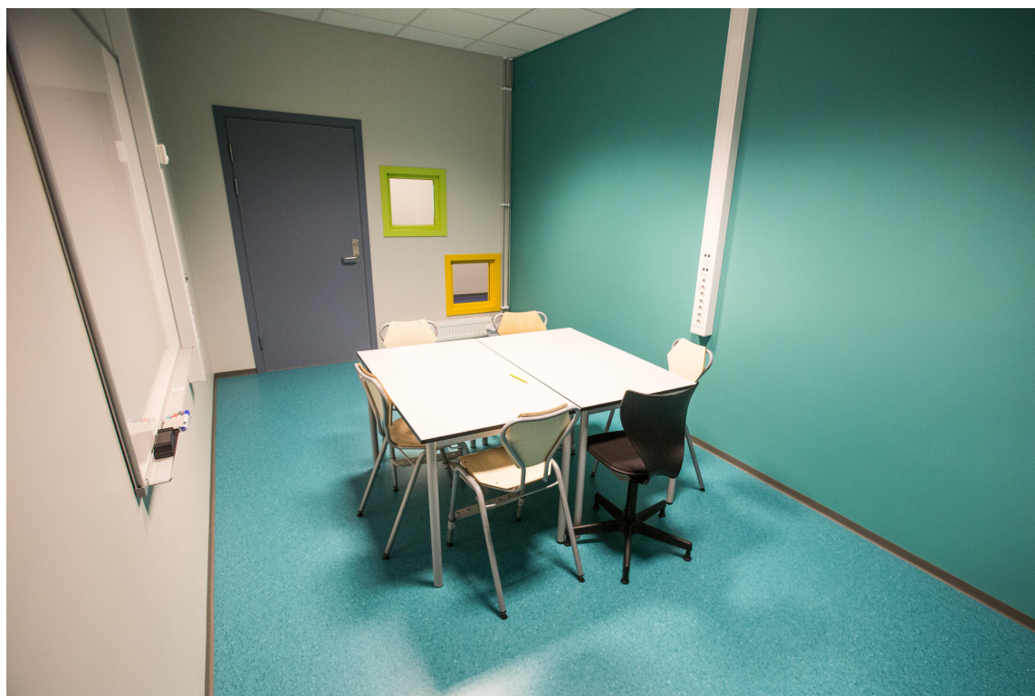
SPREKE FARGER: Øyehaug har jobbet mye med fargevalget. Grupperommene har omtrent samme farge på én vegg som det er på gulvet. Her er belegget iQ Granit Seapunk 3040464, og veggfargen er NCS S 3030-B70G.
