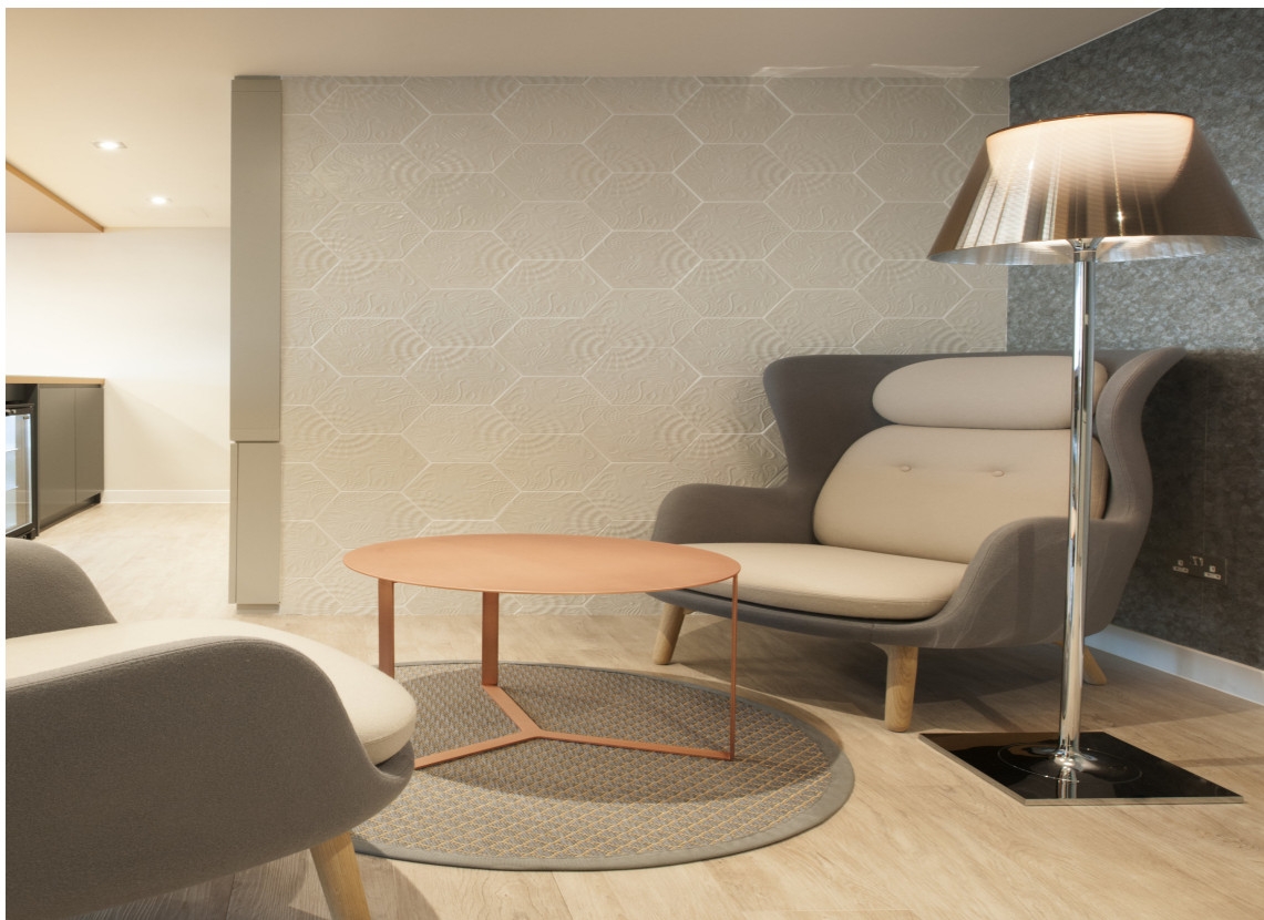
LEGGES LØST: Med LVT for løstlegging får du et nytt gulv, uten at det eksisterende gulvet skades. Montering går raskt og uten støv og støy. (Foto: Polyflor)
