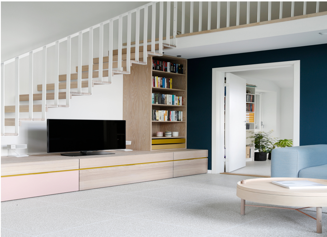
SMALE FUGER: Flisene er store og fugene smale. Slik oppnås et gulv som opptrer rolig og mest mulig som én flate.
