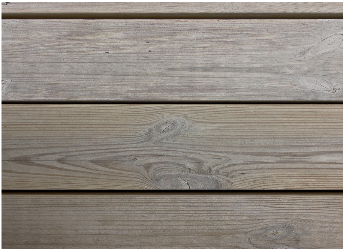
GRUNNSTOFF: Silisiumkrystaller penetrerer treverket, og danner en fysisk barriere slik at fukt, sopp og andre organismer ikke kan trenge inn i materialet på mange år. (Foto: Bjørg Owren/ifi.no)
