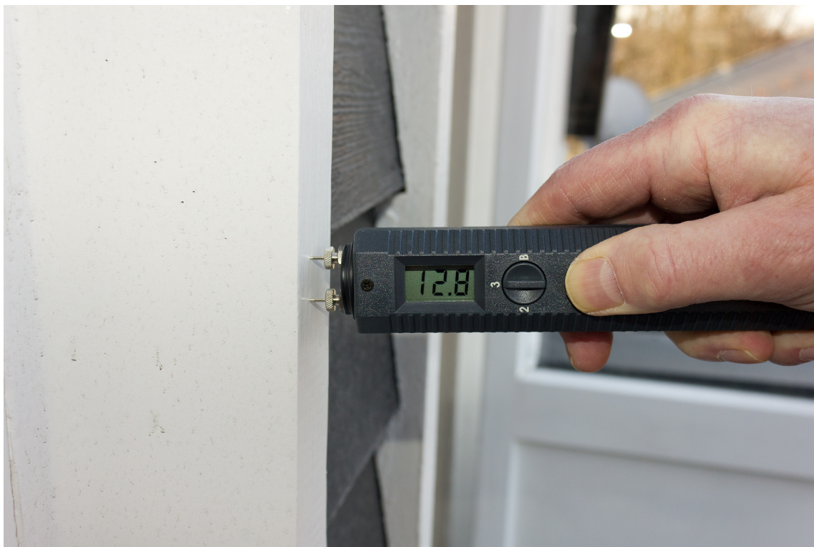
FUKTSJEKK: En fuktmåler gir bra indikasjon på om treverket er tørt nok. (Foto: Chera Westman/ifi.no)
