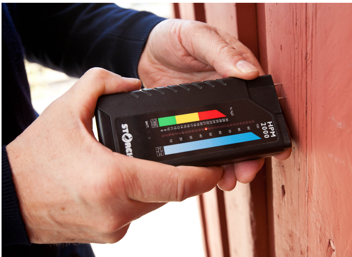
TØRT TRE: Før treverk males skal det ikke inneholde mer enn 16 prosent relativ fuktighet. Dette måles med en enkel fuktmåler.
