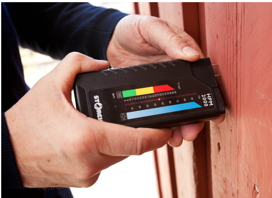
FUKTSJEKK: Treverk som males skal ikke inneholde mer en 16 prosent relativ fuktighet. Det undersøkes med en fuktmåler.
