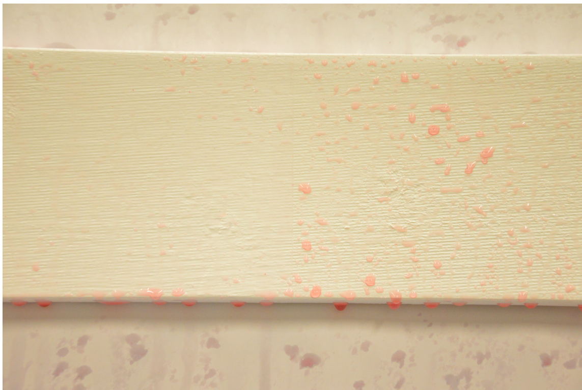
REGNER BORT: Med en selvrensende maling holder en lys fasade seg ren og pen lenge. Regnvannet samles til større dråper som tar med seg skitt. (Foto: Butinox Futura)
