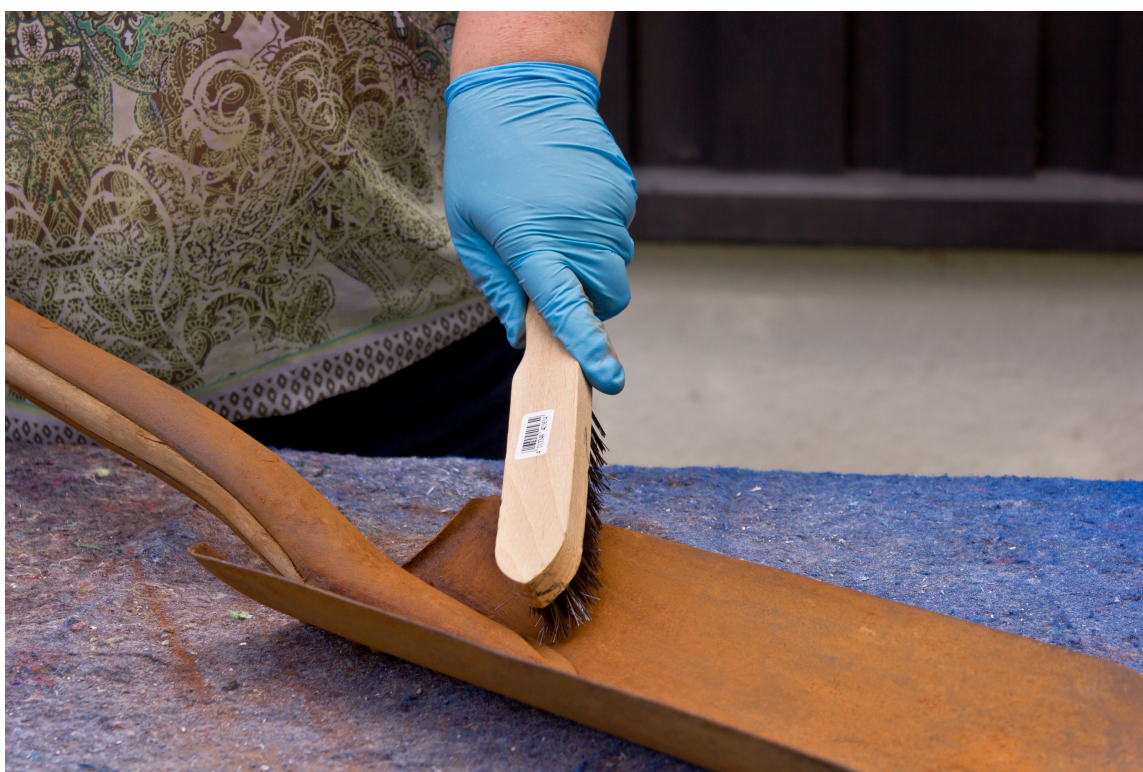
RUSTFJERNING: Løs rust børstes vekk. Fast rust lar du sitte igjen. (Foto: Chera Westman/ifi.no)
