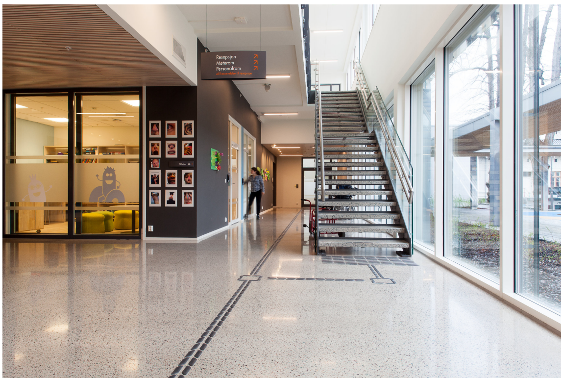
MATT: Noen av elevene med synsforstyrrelser kan reagere på refleksjoner i blanke flater. Derfor er alle vegger i bygget malt med matt maling.
