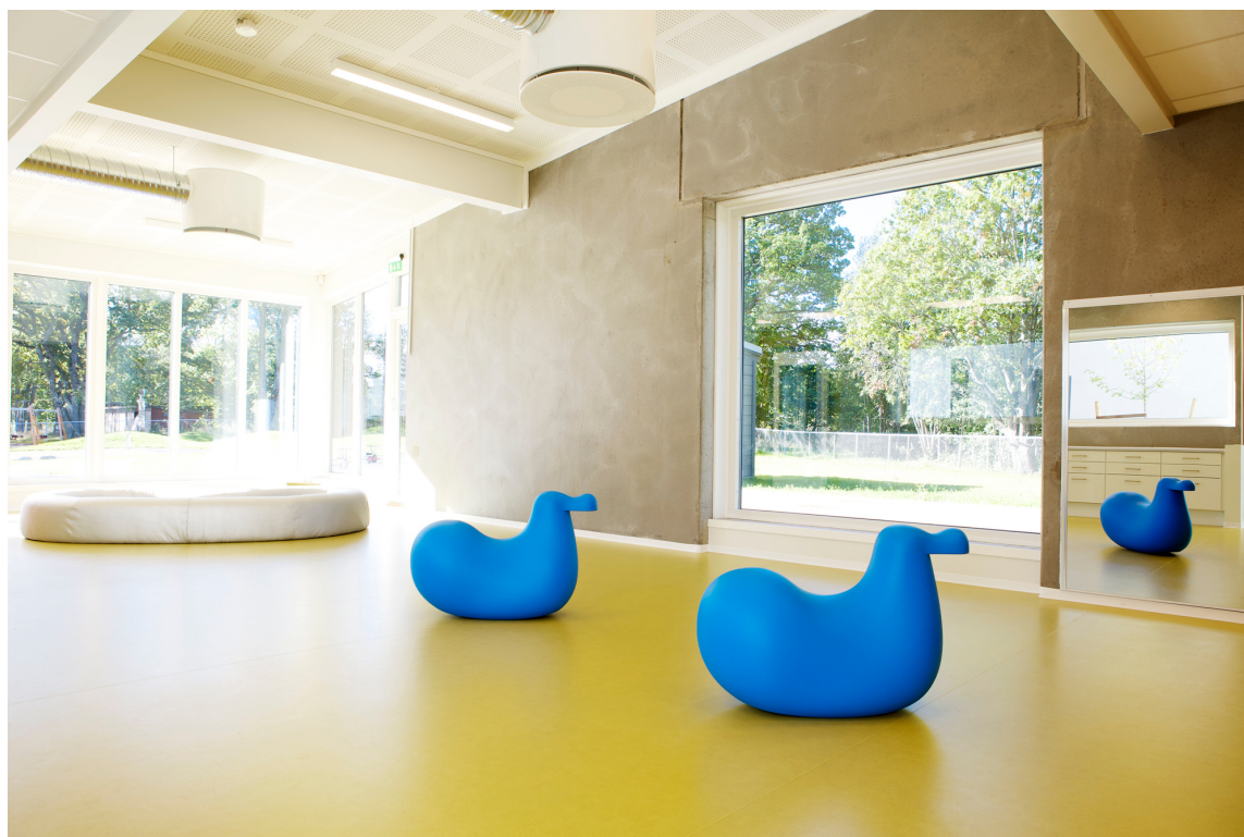
DEMPET: Belegg med akustisk bakside demper lyder nedover, og gir en god trinnlydsreduksjon. Jo tykkere skum- eller korkmementsjiktet er, dess bedre dempes trinnlydene. En myk overflate og skumbakside demper også trommelydene godt. Foto: Gerflor
