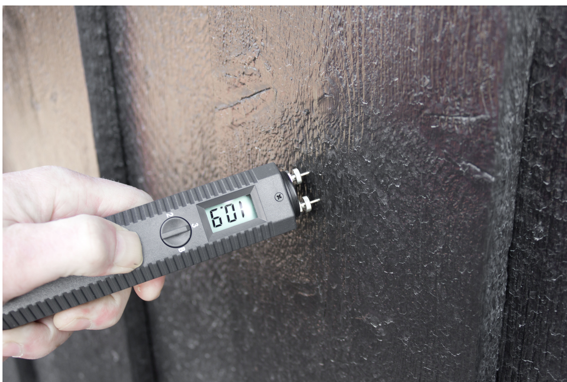
Fuktmåleren er et viktig verktøy for den som skal male. Treverket skal ikke inneholde mer en 15-16 prosent fukt. Foto: Chera Westman/ifi.no
