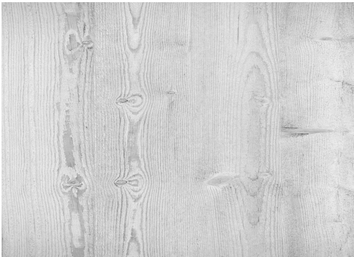
Den silisiumholdige væsken trekker inn i treverket og danner silisiumkrystaller som stabiliserer og forsteiner treet. Foto: Sioo:X
