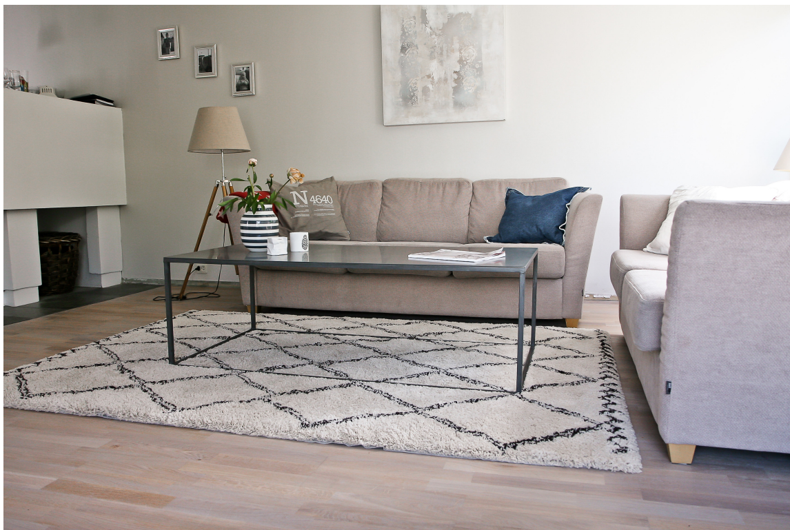
Etter sliping og behandling med en pigmentert hardvoksolje fra Alanor, ser gulvet nytt og fersht ut. Hardvoksoljer kan brukes på nye og på tidligere oljebehandlede flater. Er flaten lakkert, må lakken slipes vekk først.
