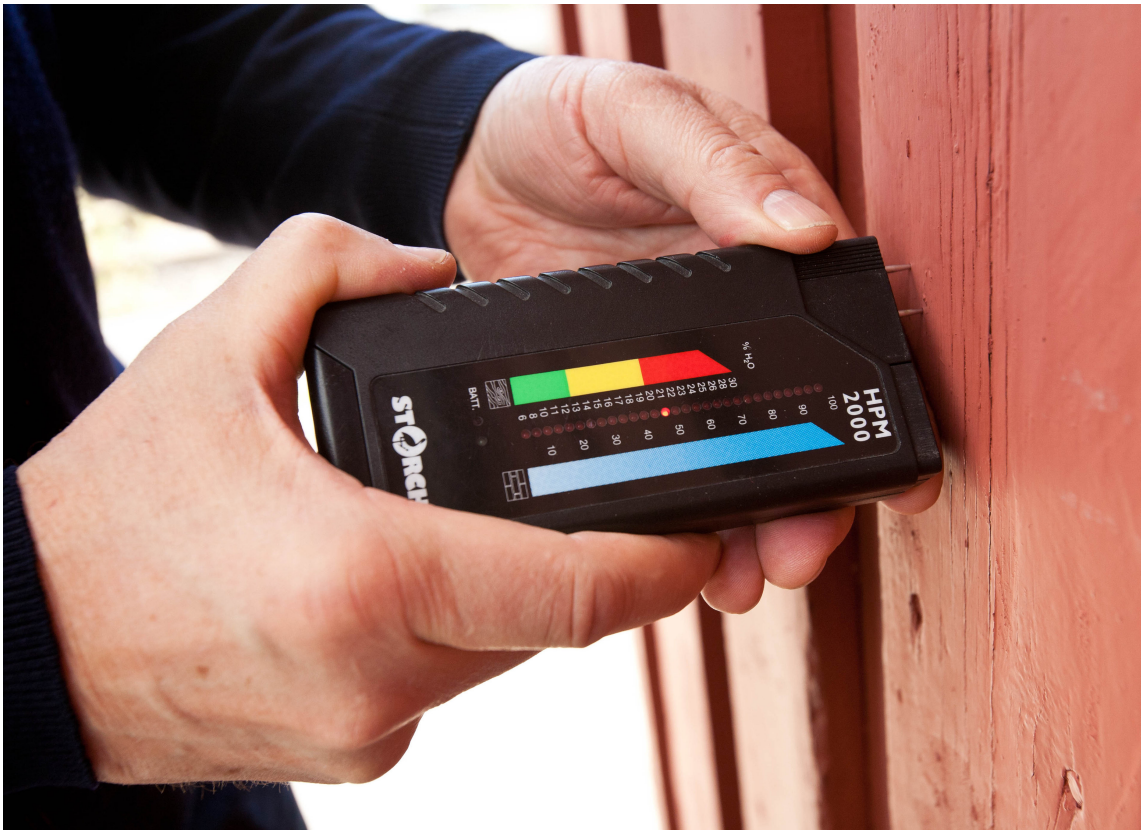
Sjekk at treverket er tørt med en fuktmåler.
